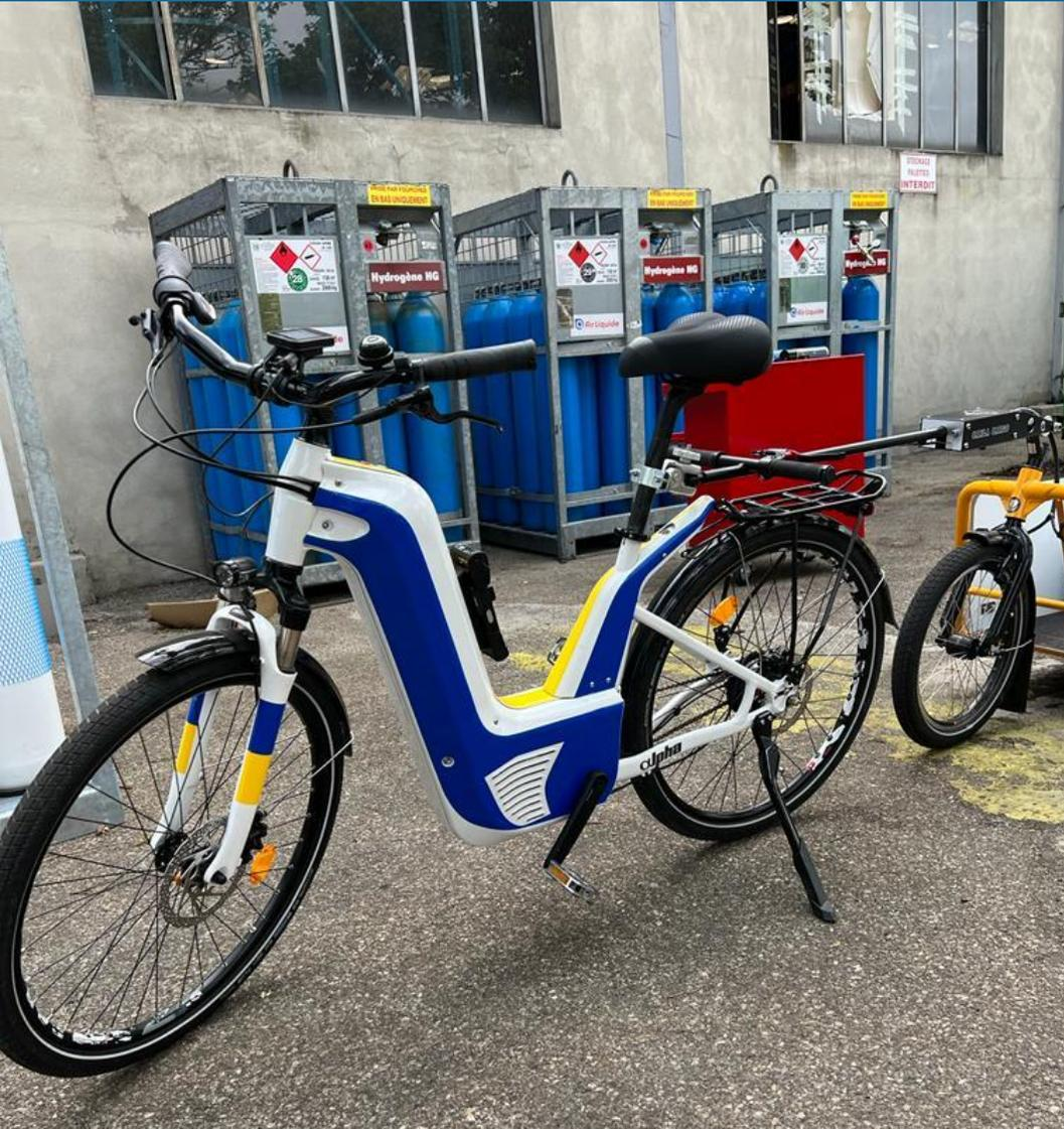
Le vélo à hydrogène est un **Vélo à Assistance Électrique (VAE)** dont l'énergie électrique est produite à partir de l'hydrogène stocké dans le réservoir. C'est un vélo à assistance au pédalage: l'assistance est fournie uniquement lorsque l'utilisateur pédale. L'assistance est limitée à une **vitesse de 25 km/heure**. La puissance nominale fournie est de **250 W** maximum.
